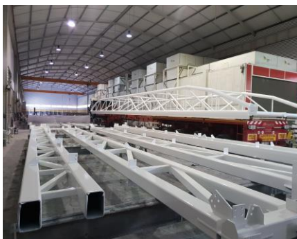
a) Expedição da estrutura metálica para a obra
