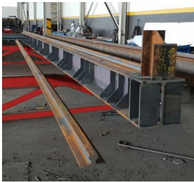
a) Armação e preparação da viga carril
